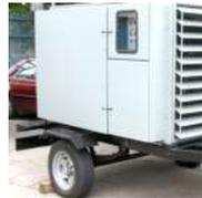
Para permitir el funcionamiento a la intemperie en zonas con presencia de nieve se dispone de una estructura diseñada a tal efecto, que eleva el equipo del nivel del suelo y lo protege con un techo a dos aguas.
